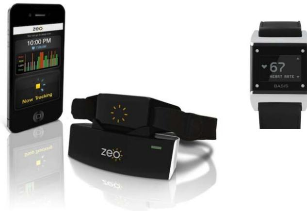
Fig. 13: Da esquerda para a direita, temos o aplicativo móvel do Zeo que recebe os dados captados pela bandana, o conjunto bandana mais unidade receptora e o dispositivo Basis, que tem o formato de um relógio.
