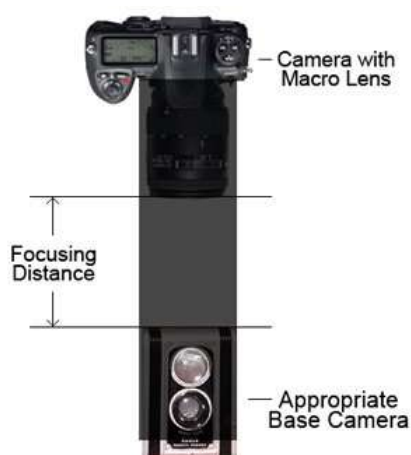
Esquema visual da técnica “ Through the Viewfinder ” e fotografia da exposição ITV
