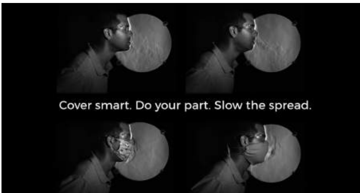
Figura 4.2 - Comparação do fluxo de ar bucal e nasal com e sem máscara. Fonte: National Institute of Standards and Technology (NIST).
