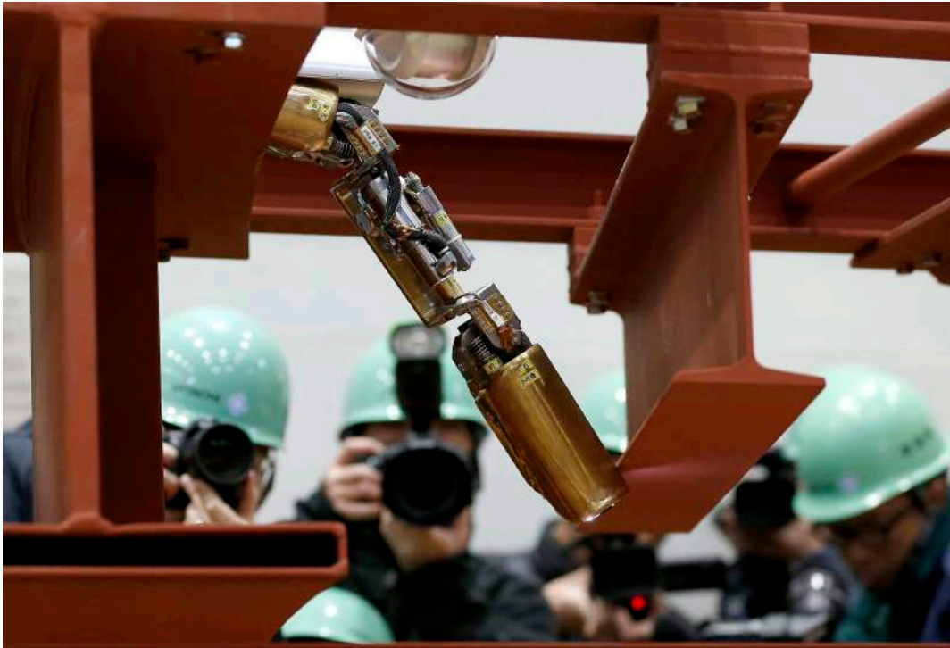
Figura 38 - Robot serpiente diseñado ad hoc para filmar dentro de Fukushima Daiichi. Fuente: TOSHIBA.
