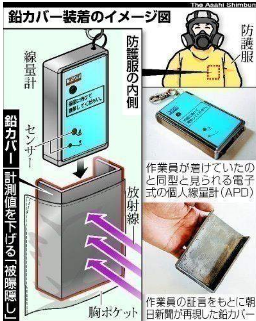
Figura 28 - Pieza de plomo empleada para ocultar las mediciones personales de radiación. Fuente: Asahi Shimbun.
